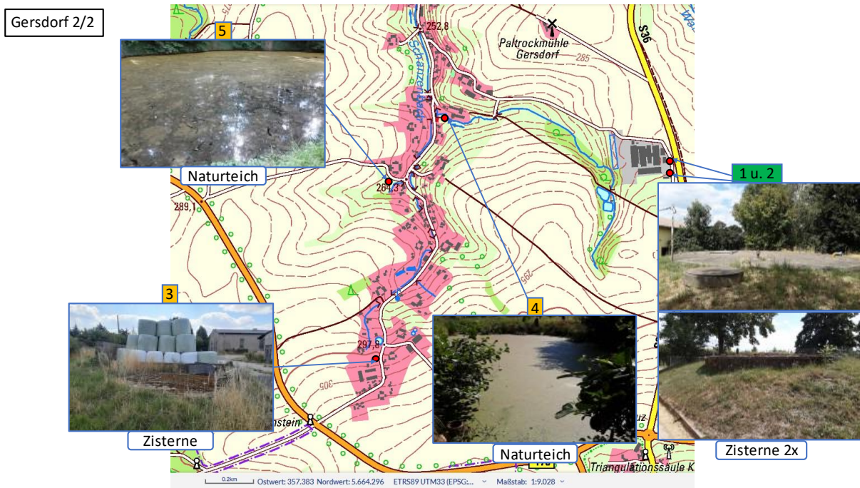
Abbildung 6 Löschwasserentnahmestellen Ortsteil Gersdorf 2/2 [1]
