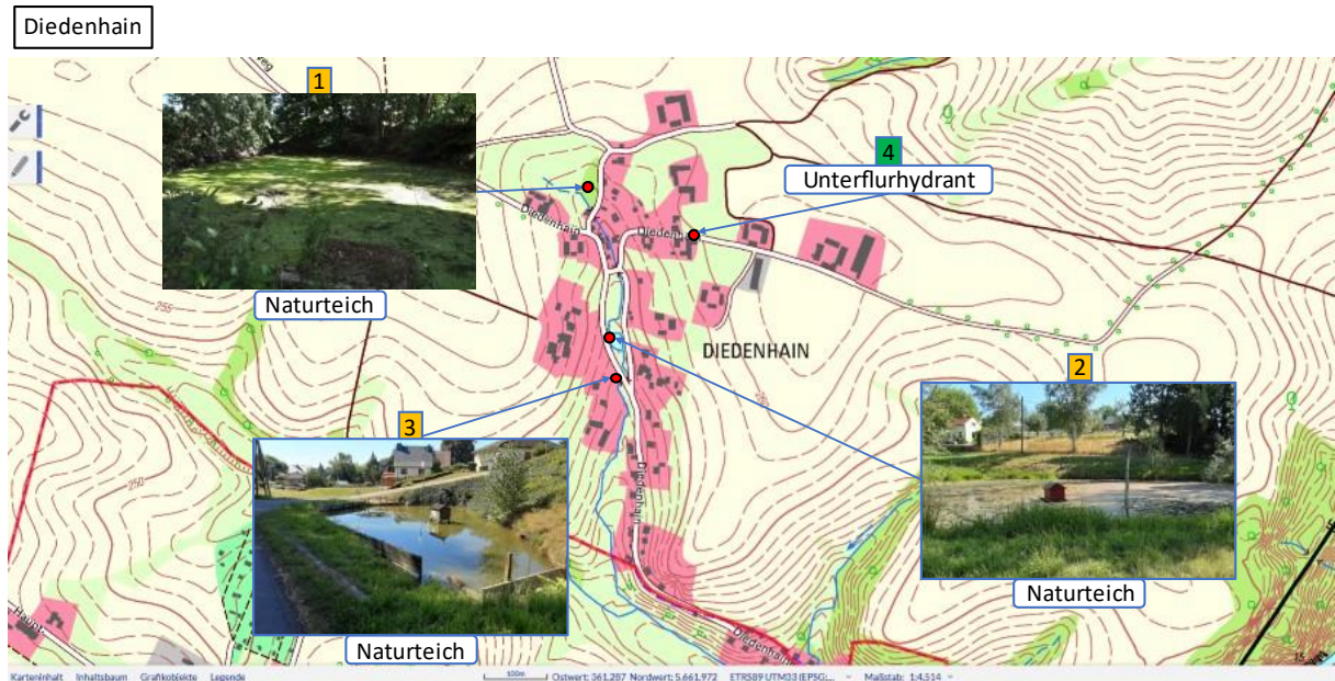
Abbildung 3 Löschwasserentnahmestellen Ortsteil Diedenhain [1]
